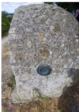
Repère de nivellement sur la Dhuis
